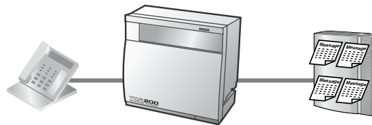
1.9.3 Připojení záznamového systému
